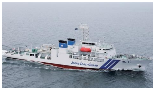
測量船：平洋 総トン数：4,000 トン 全長：103.0m
