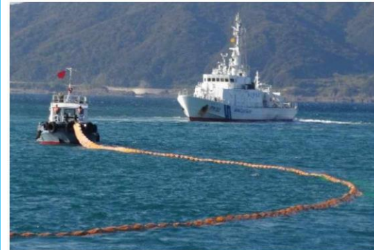
オイルフェンス 展張訓練
