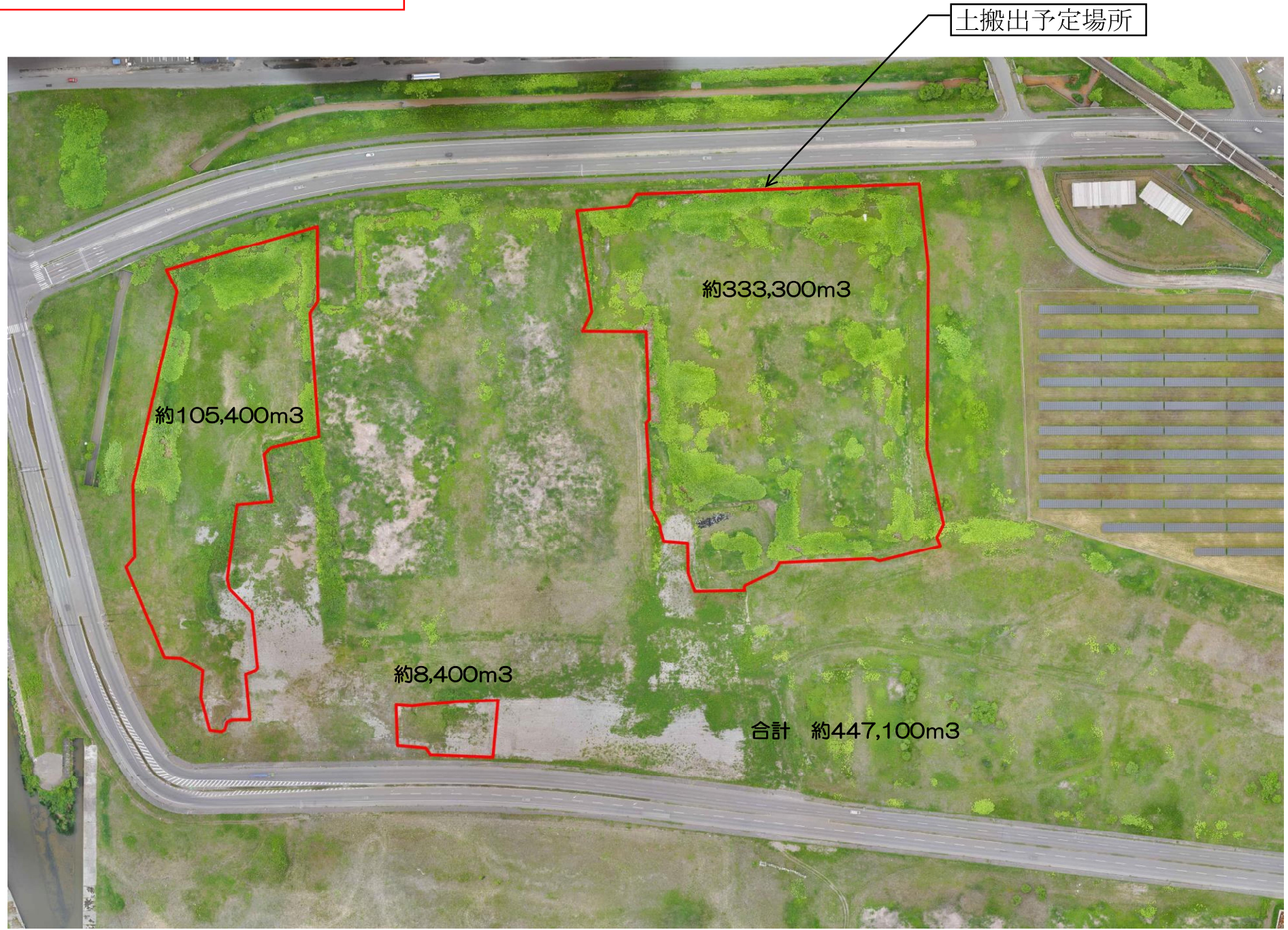
別図：盛土用土砂堆積場所
